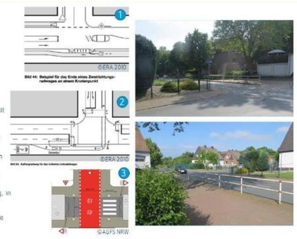
Das Diagramm zeigt drei alternative Querungsanlagen für die Bachstraße. Alternative 1 ist eine einfache Querung mit Markierungen. Alternative 2 zeigt eine Querung mit Signalisierung und indirektem Linksabbiegen. Alternative 3 zeigt eine Querung mit Aufpflasterung, vorgezogenen Seitenräumen und einem Fußgängerüberweg. Rechts daneben sind zwei Fotoaufnahmen der Straße zu sehen, die die aktuelle Situation und die geplante Querung zeigen.
